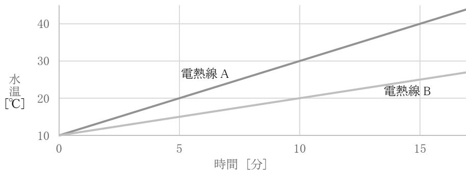
問1 電熱線 A が1分間に発生させた熱量を求めよ。
